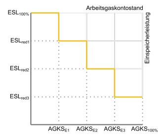
Die maximal nutzbare Einspeicherleistung unterliegt folgender Kennlinienrestriktion:
