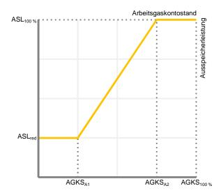
Die maximal nutzbare Ausspeicherleistung unterliegt folgender Kennlinienrestriktion:
