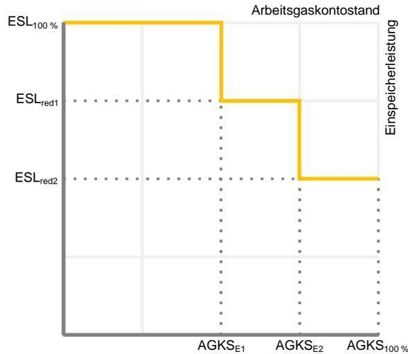
Die maximal nutzbare *Einspeicherleistung* unterliegt folgender Kennlinienrestriktion:
